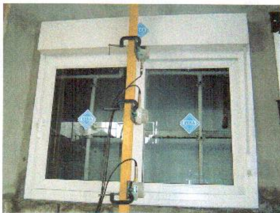
Foto nº. 04 Verificação do comportamento quando submetido às cargas uniformemente distribuídas.
